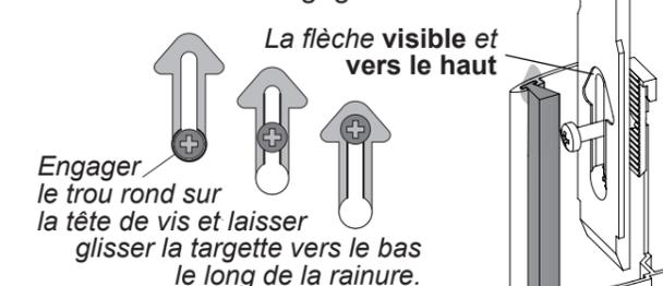
9 Serrer les vis jusqu'à arriver en butée sur les targettes.
